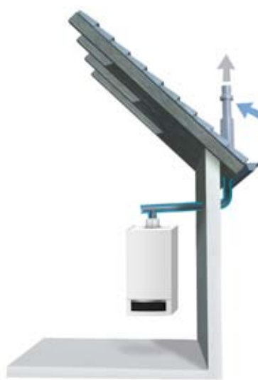
Raumluftunabhängige Aufstellvariante mit Rohr-in-Rohr-Kunststoff-Abgassystem (Aussenfassade)
